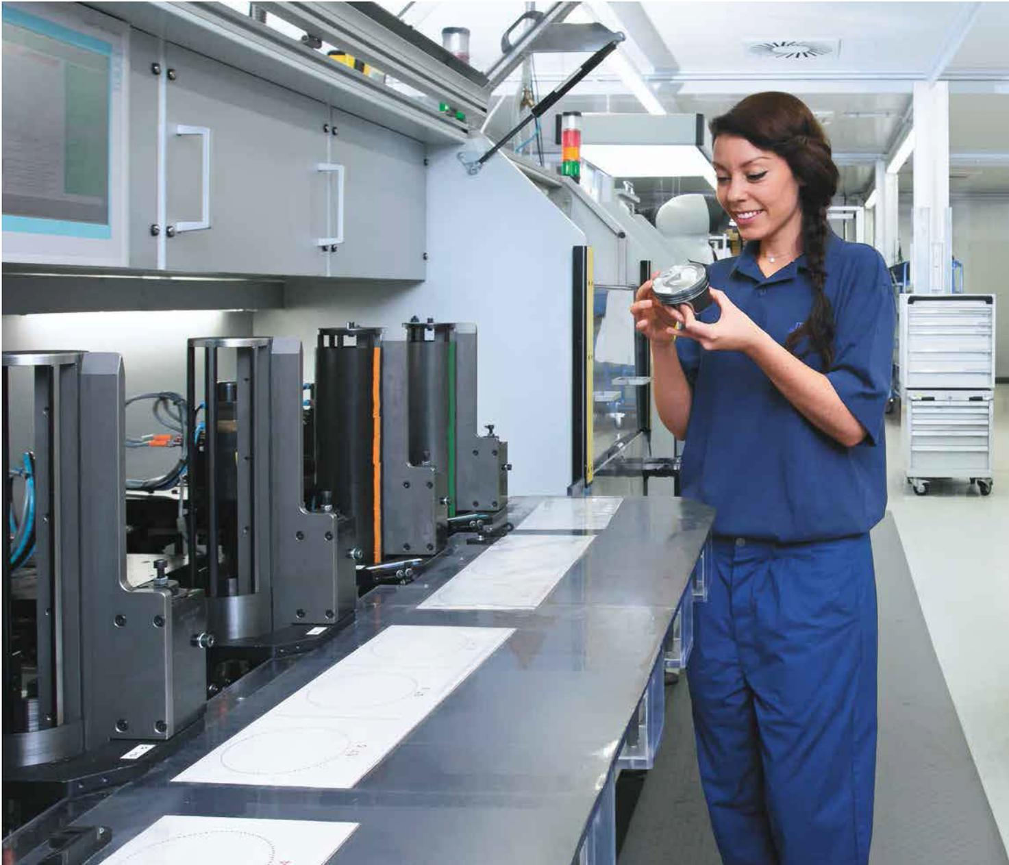
*Mitarbeiterin beim Rüsten einer automatisierten Kolben-Mess- und Kolbenring-Montageeinrichtung*
