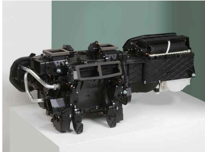
*Die neueste Generation der Vierzonen-Klimageräte ist leichter und leistungsfähiger. Verschiedene Klimagrundkonfigurationen und Temperaturschichtungen sorgen für einen optimalen thermischen Innenraumkomfort.*
