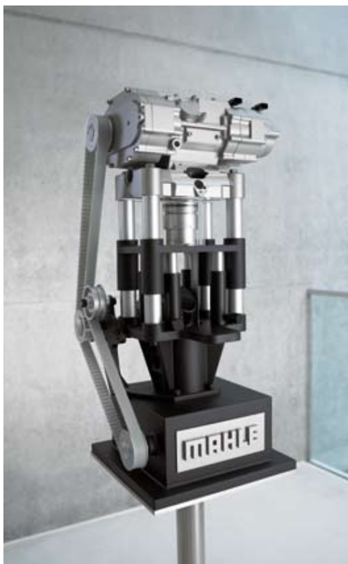
1-Zylinder-Forschungsmotor mit optischer Zugänglichkeit zum Verbrennungsraum im Zylinder-kopf und Zylinder durch hochfeste Quarzzylinderlauf-buchse sowie Kolben mit Saphirglasboden.
