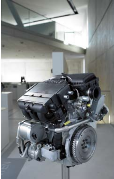
MAHLE Powertrain // MAHLE Downsizing-Motor, ausgestattet mit modernsten Technologiebausteinen von MAHLE. Ermöglicht Einsparpotenzial bei Verbrauch und Emissionen von bis zu 30 Prozent.
